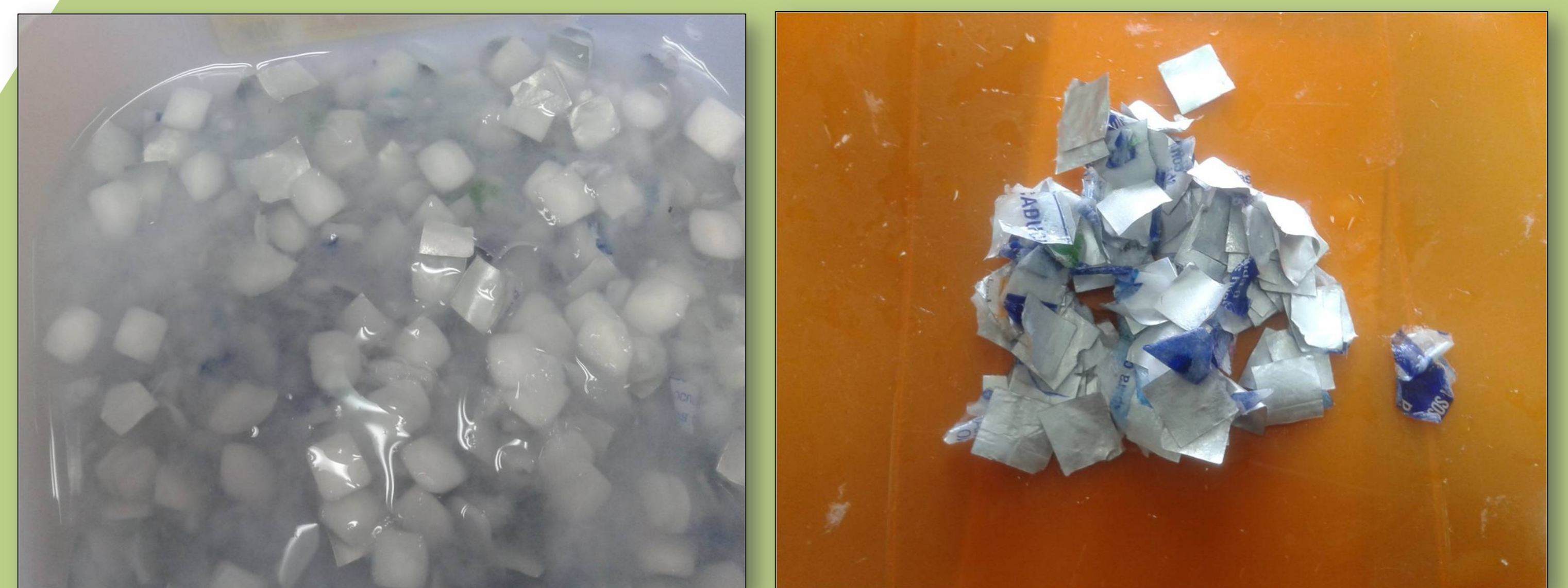
Figura 2. Componentes del envase multicapa: a) Pasta de celulosa obtenida del envase multicapa, b) residuos de aluminio y plástico del envase.
